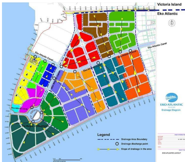
Figure 16 Schéma de l'écoulement de l'eau dans les différentes zones du système de drainage d'Eko Atlantic vers les différents points de rejet du drainage et dans le canal Eko Atlantic
